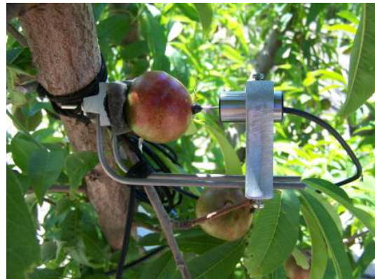
Bild 16. Instrumente zur Auswertung der bodenklimatischen Auswirkungen auf die Kohlenstoffbilanz bei Obstbäumen in verschiedenen Gebieten der Region Murcia 22
