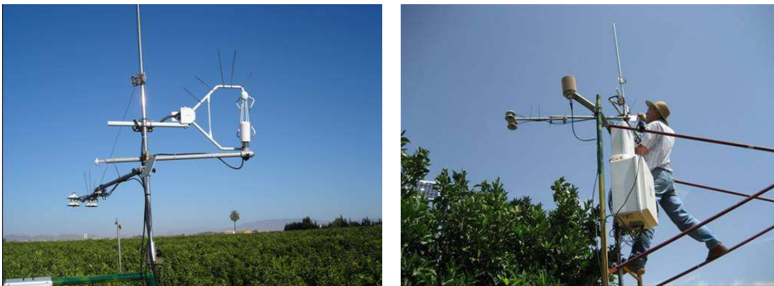
Bild 15. Ansicht des Eddy-Kovarianz-Systems (Schallanemometer, CO 2 - und H 2 O-Analysegerät) zur Messung von CO 2 -Fluss und Evapotranspiration, eingerichtet von der Universität Cartagena.
