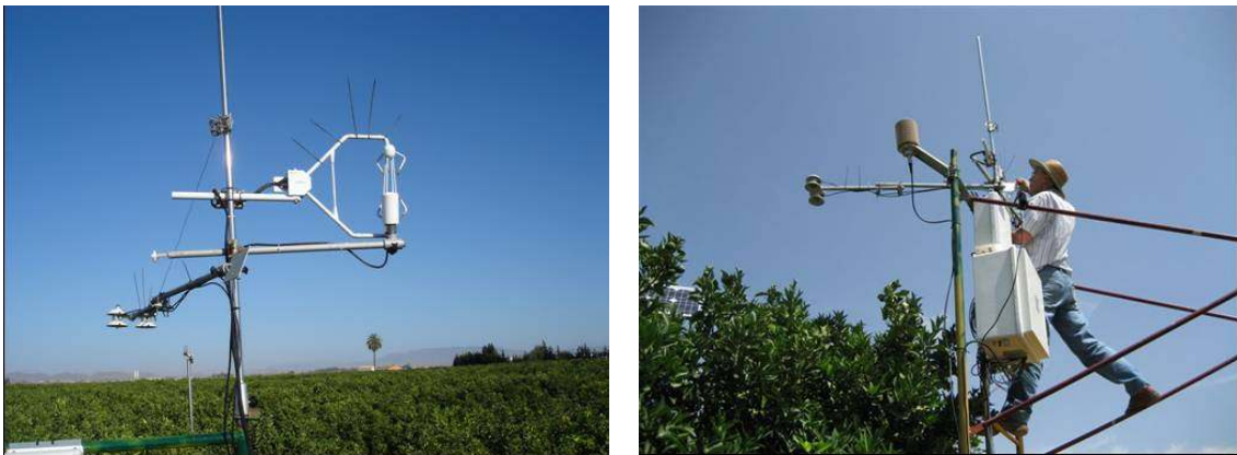
Figuras 15. Vista del equipo de eddy-covariance (anemómetro sónico, analizador de CO 2 y H 2 O) para la medida del flujo de CO 2 y de evapotranspiración instalado por la Universidad de Cartagena.
