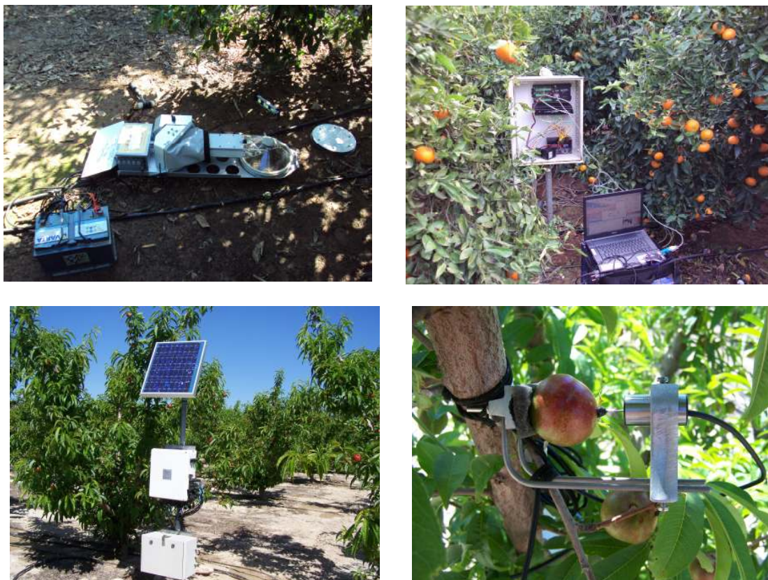
Figura 16. Instrumental aplicado para evaluar los efectos de los factores edafoclimáticos en el balance de carbono en frutales cultivados en distintas zonas de la Región de Murcia 22 .
